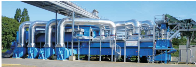
Bandrockner mit vollständiger Abluftrückführung
