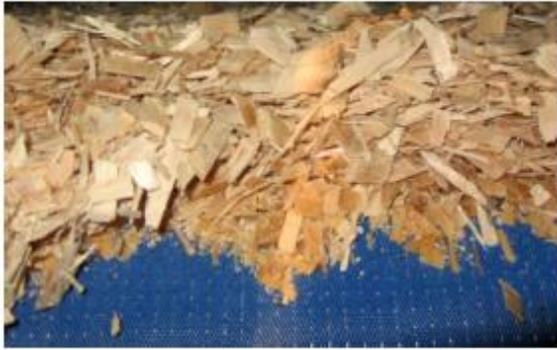
Das hochfeste Trockner-Band zum Transport des Materialstroms benötigt in der Regel keine zusätzliche Entstaubungsanlage.
